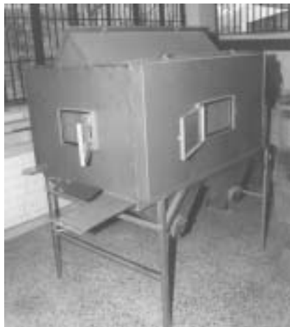
Fig.2 Módulos o depósitos para el secado del café
